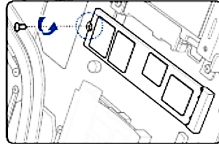
M.2 SSD modülünün vida yardımıyla sabitlendirilmesi
